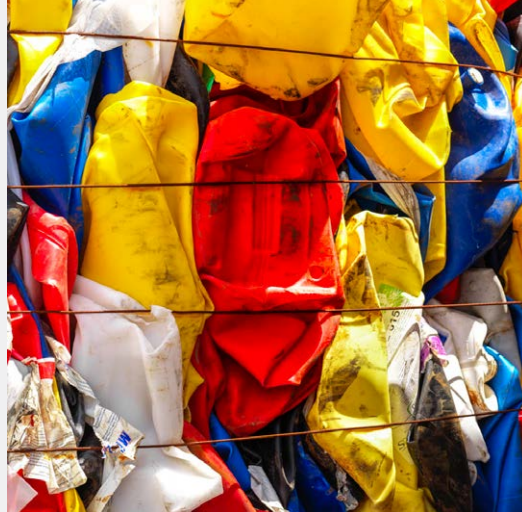
BIDONS AGRICOLES Bidons vides compressés. Les bidons plastiques sont vidés et rincés par les agriculteurs lors de l'utilisation des produits. Ces emballages sont pressés en bales compactes d'environ 400 kilos, puis transportés vers une usine de recyclage. www.advalor.fr
